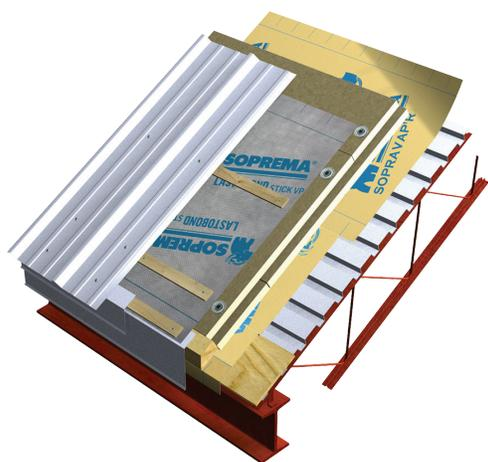
LASTOBOND STICK VP est une membrane autocollante de sous-toiture pare-pluie perméable à la vapeur d'eau composée d'un complexe trilaminaire de polypropylène en surface.
